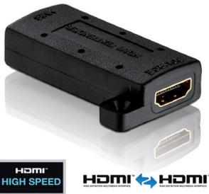
Passive HDMI Kabel können ein 1080p Signal nur bis maximal 15 Meter übertragen. Ab dieser Länge ist der Signalverlust zu groß, die Folge sind „digitaler Schnee“, Bildstörungen oder gänzlich leere Bildschirme. Der PureLink HDMI Repeater PI090 ist ein intelligenter HDMI Verstärker und vergrößert die maximale Kabellänge zwischen Wiedergabegerät und Videoquelle bei voller HDTV-Auflösung auf bis zu 35m.
