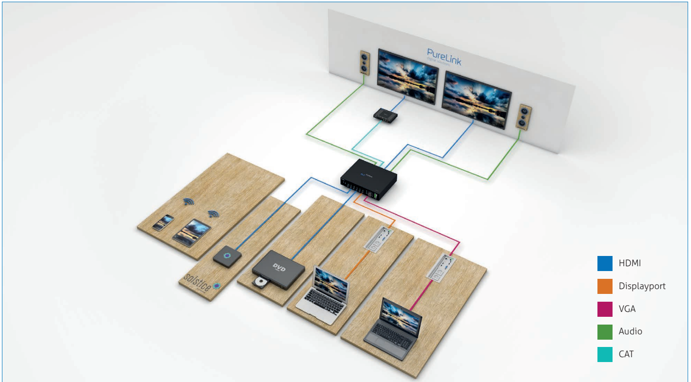
Anwendungsbeispiel in Kombination mit einem PureLink 5x2 Presentation Switcher und zwei mediahub™ Tischanschlussfeldern.
