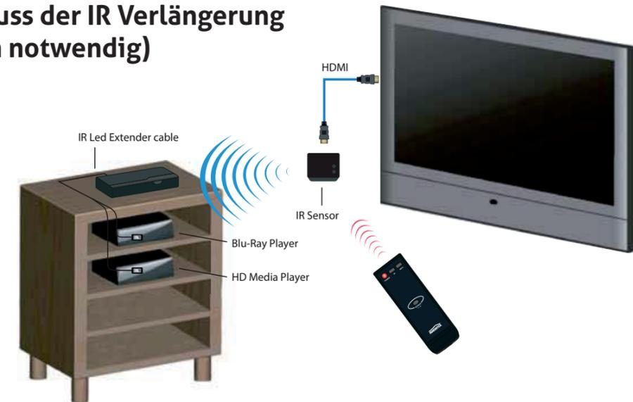
Verbinden Sie das IR LED Verlängerungskabel mit dem IR OUT Anschluss des WHD100-V2 Transmitters. Befestigen Sie die IR LED an der Vorderseite Ihrer HD-Geräte. Diese wird nun alle IR Befehle weiterleiten, die vom IR Sensor des WHD100-V2 Empfängers empfangen werden.
