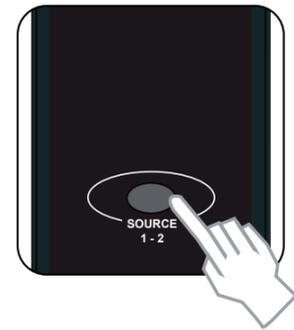
4. Drücken Sie auf die Source Taste, bis Sie das Videomaterial vom Quellgerät sehen. Die Umschaltzeit zwischen zwei Quellen kann ca. 15 ~ 20 Sekunden betragen.
