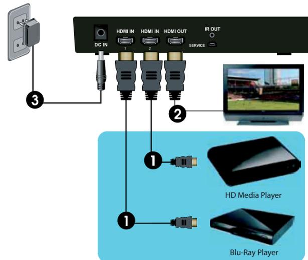
1. Schließen Sie bis zu 2 HD-Geräte (HDMI Ausgang) über HDMI-Kabel an Ihren WHD100-V2 Transmitter an. (HDMI IN)
