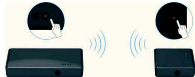
1. Steht das WHD100-V2 Set auf Standby (rote POWER LED), drücken Sie auf die Ein/Aus Taste des WHD100-V2 Transmitters & Empfängers um diese einzuschalten. Die Inbetriebnahme des Systems nimmt ca. 80 Sekunden in Anspruch.
