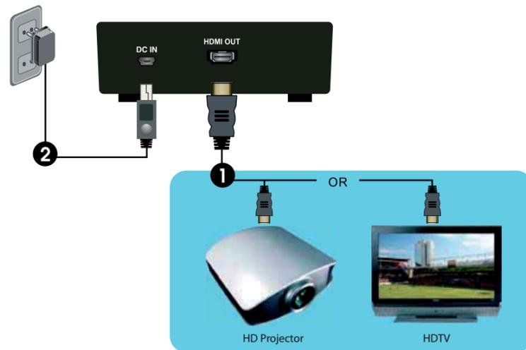
1. Schließen Sie Ihren HDTV oder HD Projektor (HDMI IN) mit einem HDMI Kabel an den WHD100-V2 Empfänger (HDMI OUT) an.
